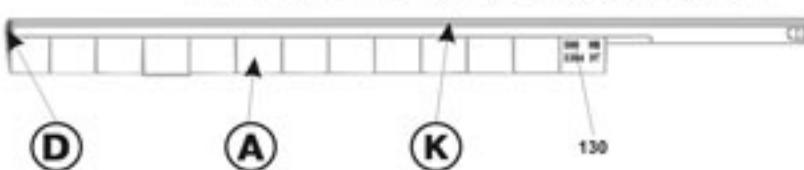
При изготовлении на заводе в Кумертау все вертолеты семейства Ка-27, получают лопасти целиком окрашенные в светлый серо-голубой (Flat Dark Blue/Grey) цвет, законцовки окрашены в ярко-оранжевый (Flat International Orange) цвет; носок лопасти - неокрашенный алюминий (Unpainted Aluminium). В процессе эксплуатации возможна окраска лопастей в другие цвета, например черный (Flat Black).
